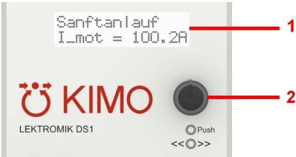
1 Display 2 Bedienknopf (Drehencoder mit Tasterfunktion)
